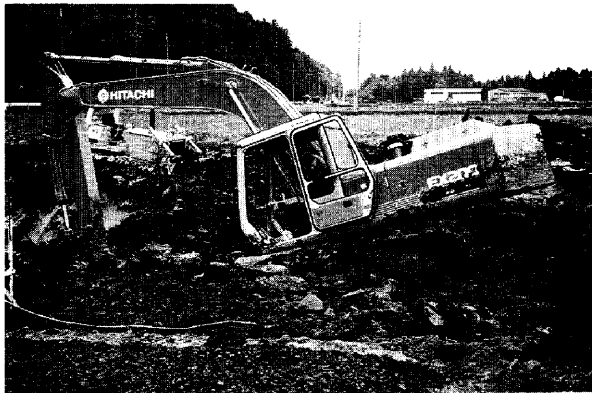
Photo 1 未改良地盤での掘削機械埋没状況
