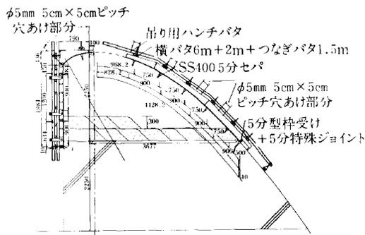
図-3 クレスト部型枠断面図
