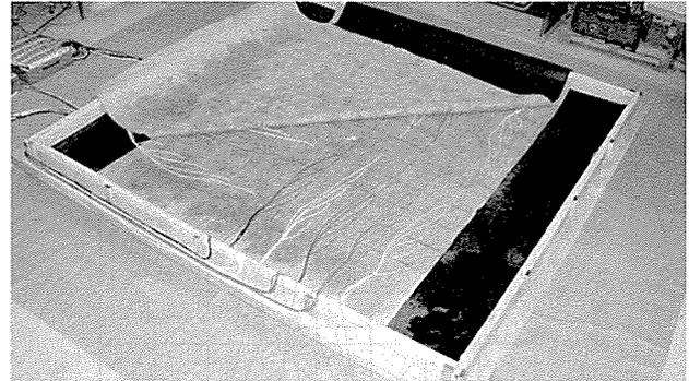
写真-2 二重しゃ水シート構造実験の電極配置
