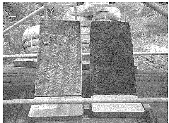
写真-8 耐侵食性試験状況 (左: 撒き出し工法, 右: 根をリサイクル工法)
