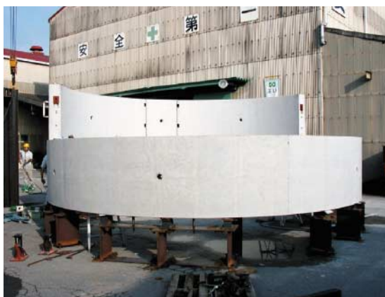
写真-7 水平組立試験状況
