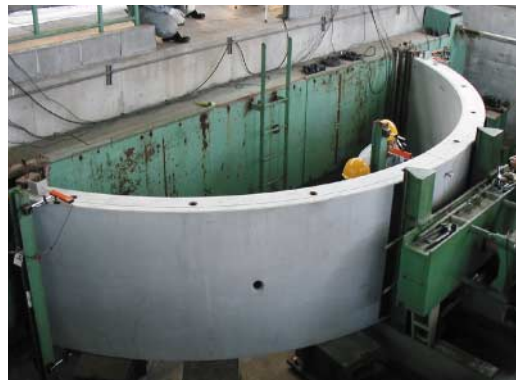
写真-5 継手曲げ試験状況
