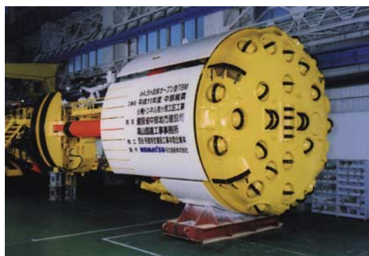
写真ー1 TBM 本体
