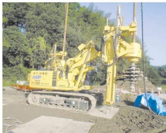
写真-1 AMP工法施工機械
