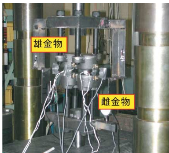
図-4 単体引張試験状況
