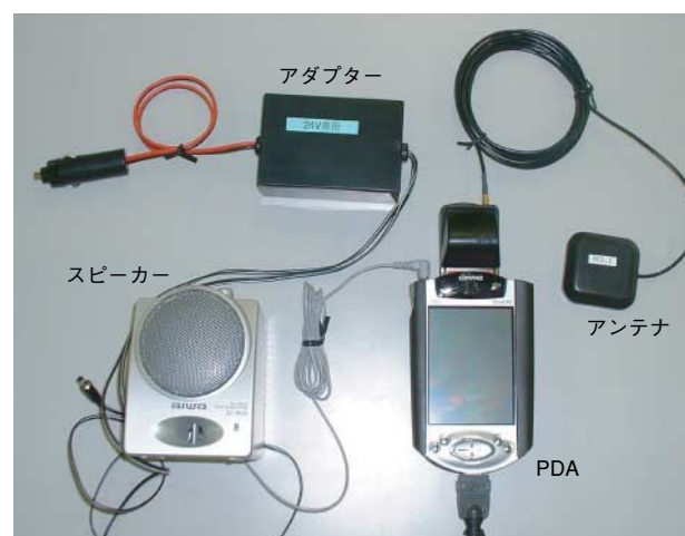
写真-3 ダンプ運行管理システム一式
