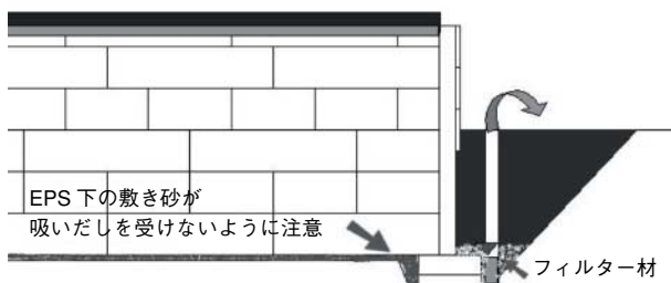
図-4 埋め戻し時の釜場排水図
