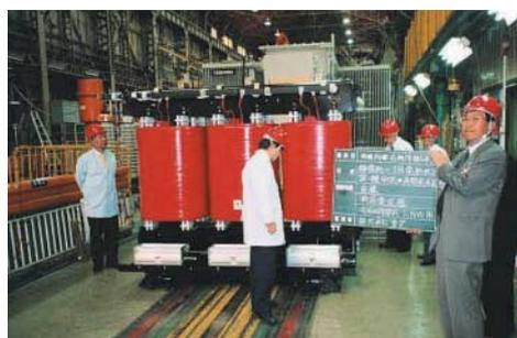
写真-2 ネットワーク変圧器(工場検査)
