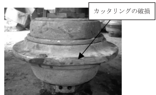
写真-7 G3 カッタ破損状況
