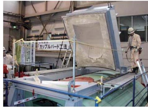
写真二2 リトラクタブルシールド掘削状況
