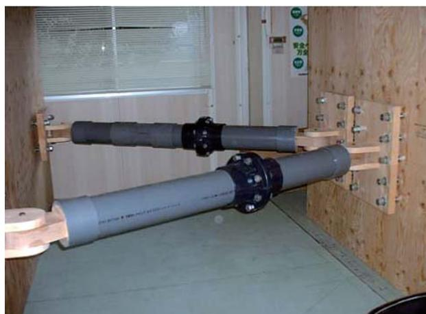
写真-7 制震ダンパーモックアップ (実物大)
