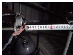
写真-8 湿式超低振動型ドリル
