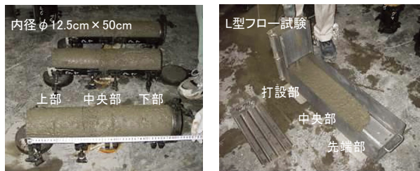
写真-6 繊維均一性確認試験状況
