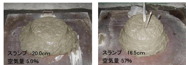
写真-7 模擬型枠打設状況
