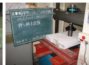
写真-7 押抜き試験
