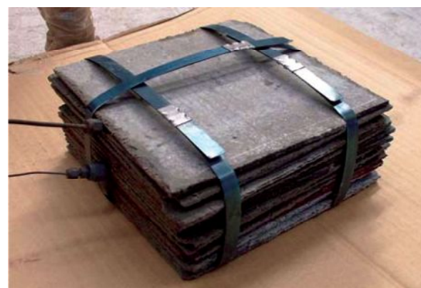
写真一2 供試材料の有姿 （住宅屋根用化粧スレート）
