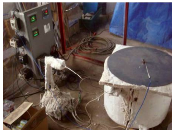
写真一3 基礎実験で使用した加熱炉
