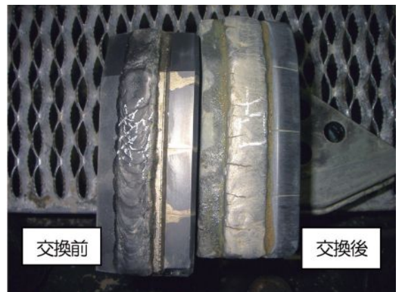
写真-2 スクレーパービット (交換時)
