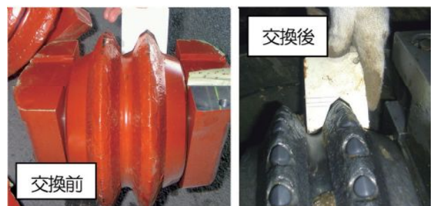
写真-3 ディスクカッタ (交換時)
