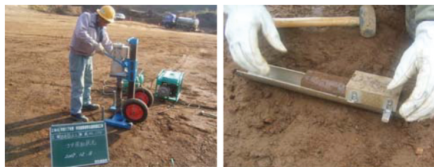
写真-1 ブロックサンプリング (左:採取状況, 右:削出し整形後)
