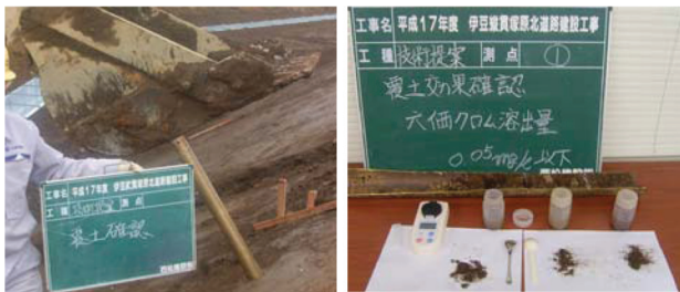
写真一3 覆土の効果確認測定状況
