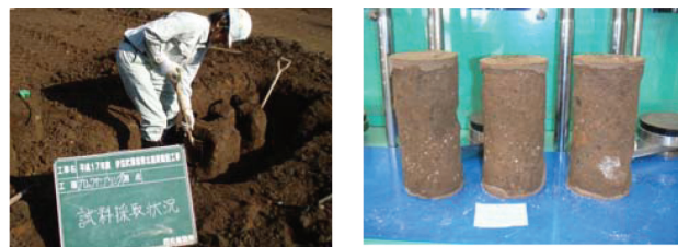
写真-1 ブロックサンプリング (左:採取状況, 右:削出し整形後)
