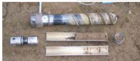
写真-2 二重管式コア採取機 (上左:採取状況 上右:コア整形, 下:コア管(二重管構造))
