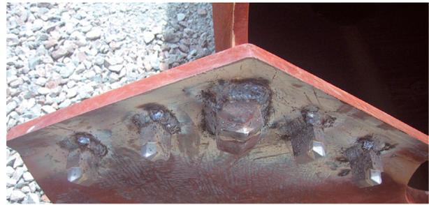
写真一2 超硬ビット取付状況
