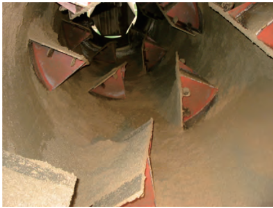
写真一六 ドラム内部のCSG 付着状況 (17回転)
