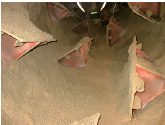
写真一七 ドラム内部のCSG 付着状況 (21回転)
