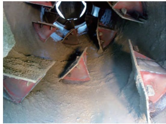
写真一14 ドラム内部のCSG 付着状況 (17回転)
