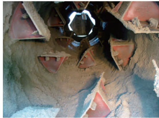
写真一15 ドラム内部のCSG 付着状況 (21回転)
