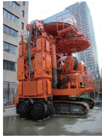
写真-2 低空頭型掘削機
