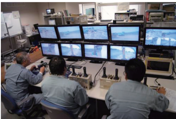
写真一五 超長距離遠隔施工 (操作室側：長崎市内)
