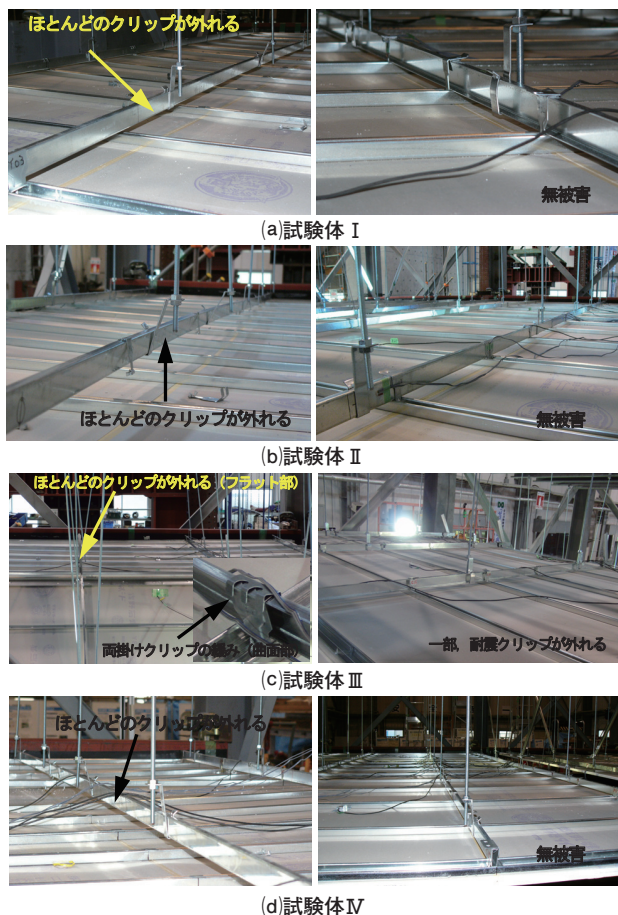
写真-6 最終破壊状況 (左：在来, 右：耐震クリップ)
