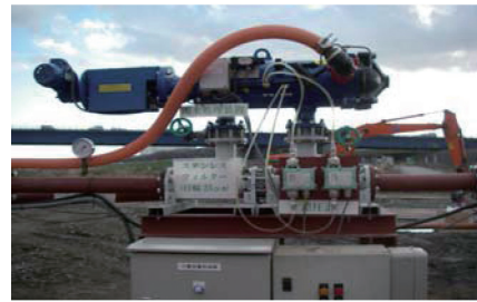
写真-1 ステンレスフィルタ濁水処理装置（実験機）
