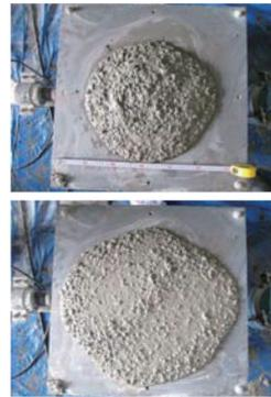
写真一五 加振変形試験
