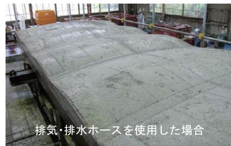
写真-8 覆工背面の仕上がり状況
