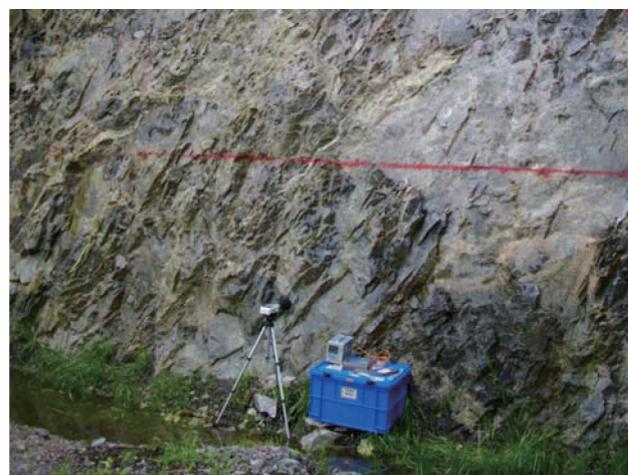
写真一2 坑口法面（音響放射面）に設置した測定機器の状況
