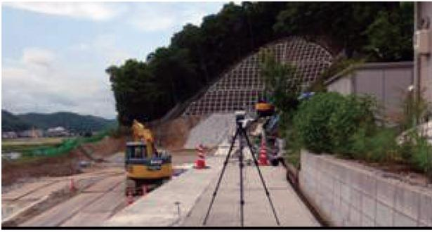
写真-4 音圧測定のための機器設置状況
