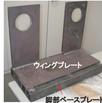
写真一 ウイングプレートと脚部ベースプレート
