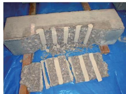
写真-3 打撃試験後のはく落状況
