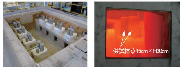
写真-2 炉内の供試体配置と加熱中の炉内状況
