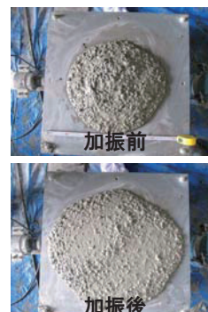
写真四 中流動覆工コンクリート変形性能と充てん性
