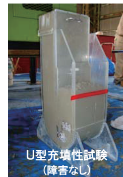
写真四 中流動覆工コンクリート変形性能と充てん性
