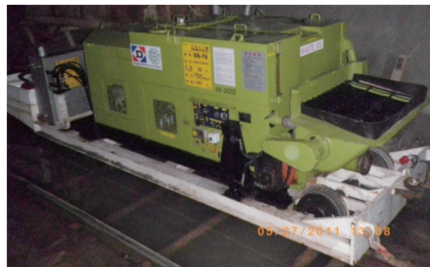
写真一六 坑内用コンクリートポンプ
