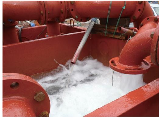
写真一3 ノッチタンク稼働状況
