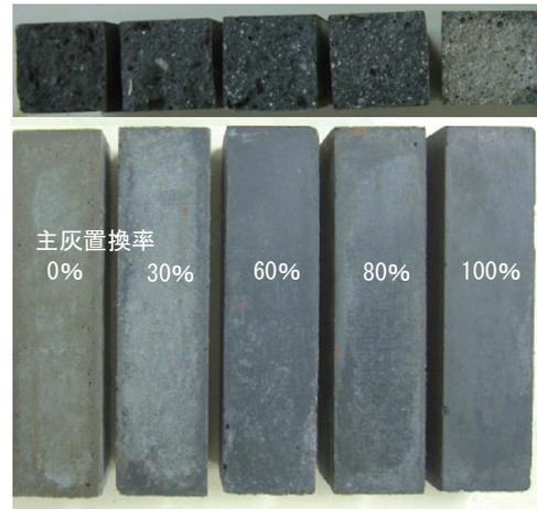
写真-3 モルタル硬化体の外観と断面状況
