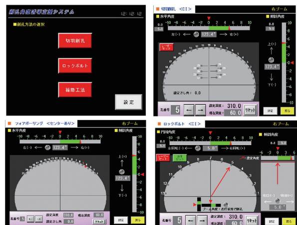
(上段右：発破孔，下段左：フォアポーリング孔，下段右：ロックボルト孔)
