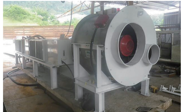
写真-4 移動式局所冷房装置
