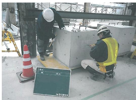
写真-11 模擬ブロック供試体(□800mm×800mm)を用いたコンクリート品質確認
