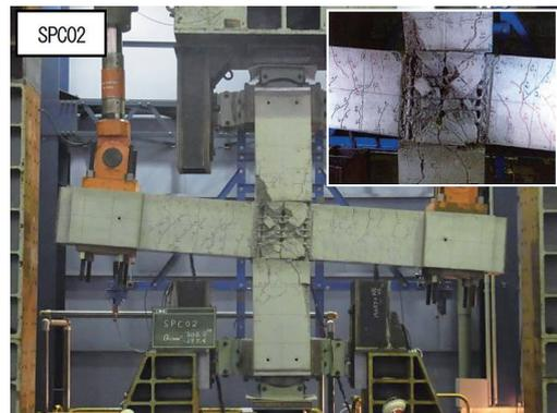
写真-4 最終破壊状況 (SPC02)
