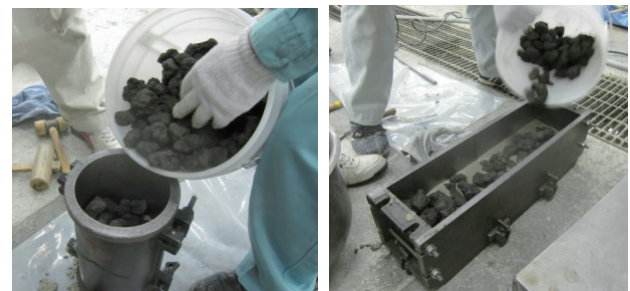
円柱 \phi 15 \text{ cm} \times \text{H}30 \text{ cm} 直方体 15 \text{ cm} \times 15 \text{ cm} \times 53 \text{ cm}
