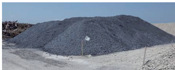
写真-1 焼却主灰造粒固化処理物の仮置き状況
