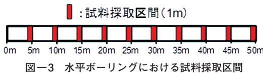
図-3 水平ボーリングにおける試料採取区間
