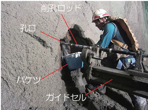
写真一 従来の試料採取状況
