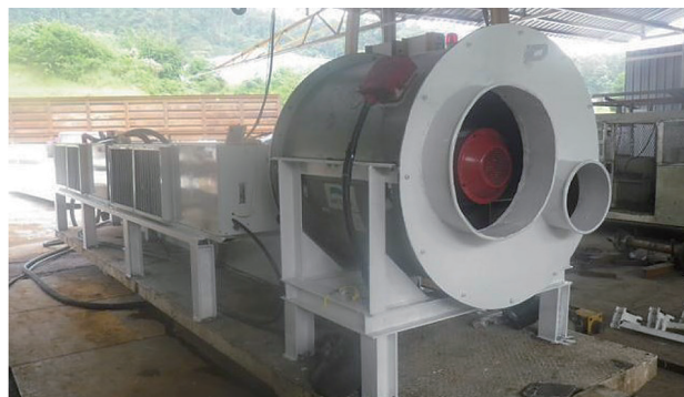
写真二 移動式局所冷房装置
