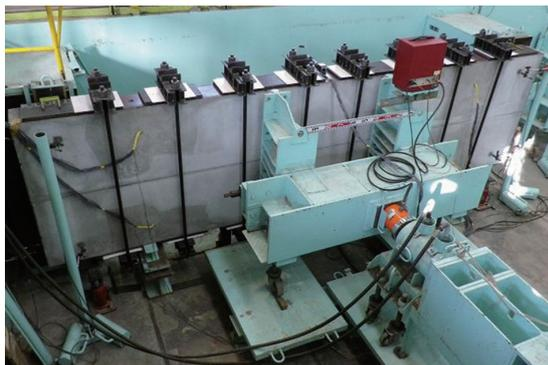
写真一2 曲げ試験状況
