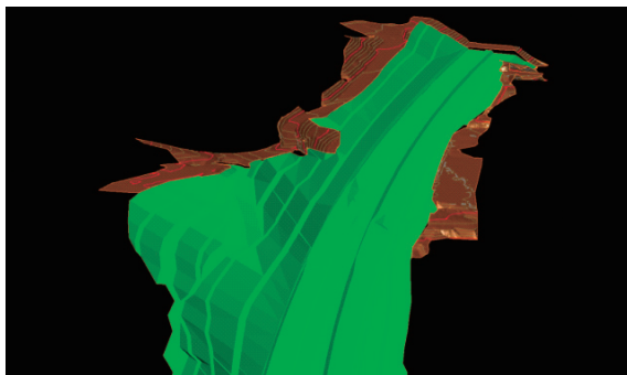
図-8 3次元設計とTIN合成データ
