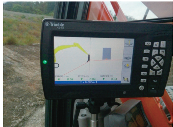
写真-3 オペレータ室ガイダンスモニター
