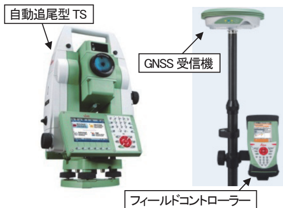
写真-4 ロードランナー測量機器
