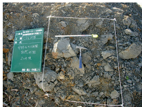
写真-7 泥岩の細粒化状況
