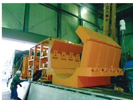
写真-3 ストラットおよび元押しジャッキ
