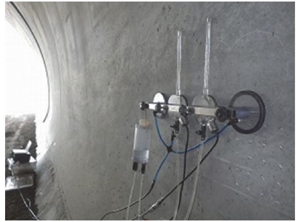
写真-5 SWAT 測定状況 (SL 部)
