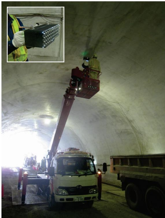
写真-10 超音波トモグラフィー法を用いた覆工コンクリート内部非破壊調査状況
