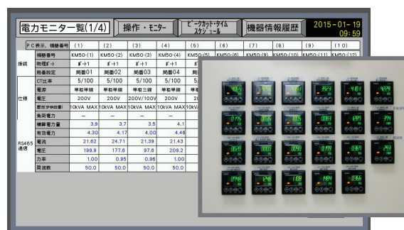
図-3 電力測定器のモニタ
