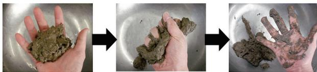
写真-1 手触りによる評価方法
