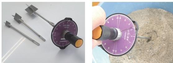
写真-3 ベーンせん断試験による評価方法
