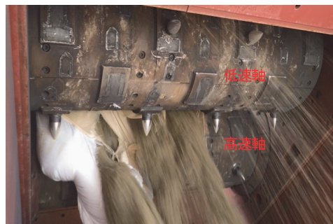
写真-4 二軸せん断式破砕機のフレコンの破袋状況
